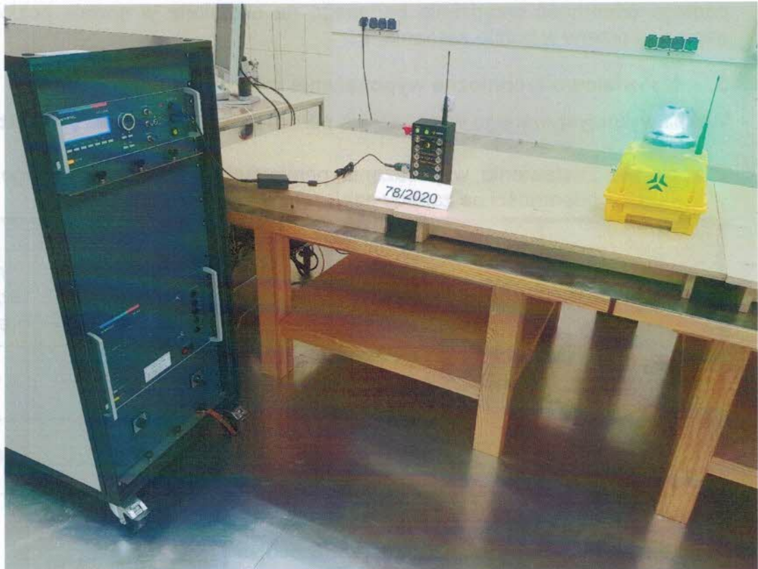
Rys. 22. Ustawienie badanego urządzenia (EUT) podczas badań odporności na zapady napięcia i krótkie przerwy.
