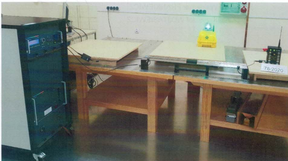
Rys. 19 Widok EUT wraz z generatorem podczas badania odporności na serie szybkich elektrycznych stanów przejściowych.
